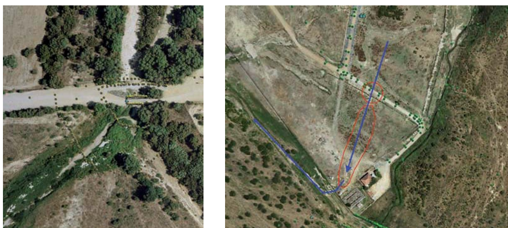
Figura 11. Izquierda: Paraje del badén-puente del Ajolí con la cañada real en el centro de la imagen tomada en 2008. El flujo circula de norte a sur y el cauce operativo del arroyo del Partido aguas abajo de la cañada real es el de la izquierda que se dirige al oeste. Los puntos amarillos en la imagen corresponden a un levantamiento topográfico realizado en 2009. Derecha: Recorrido del arroyo del Partido próximo a su afluencia en la marisma del PND, en su margen derecho se ve la estación de bombeo de El Rocío y más al oeste se señala el lugar donde se produjo un nuevo derramadero durante las avenidas de 2010 (en rojo) y la dirección de la corriente en el mismo (en azul).
