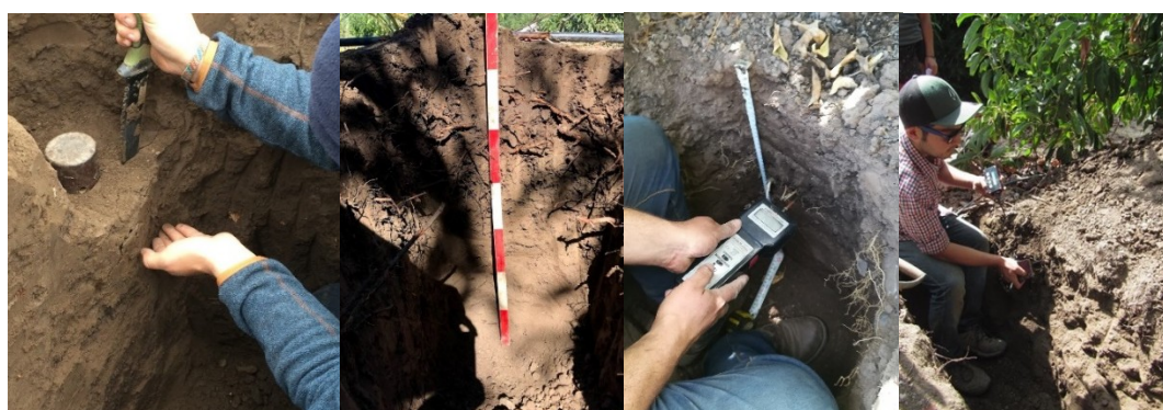
Figura 2. A) Toma de muestras para caracterización física de suelo B) Descripción morfológica de calicata, C) Evaluación de la resistencia a la penetración en el perfil de suelo con medidor de fuerza digital EXTECH, D) Implementación de evaluación sistemática del contenido de agua en el suelo con equipo TDR 100.
