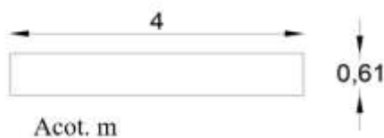
Figura 1. Sección vista en planta del canal de fondo móvil (acotación m)
