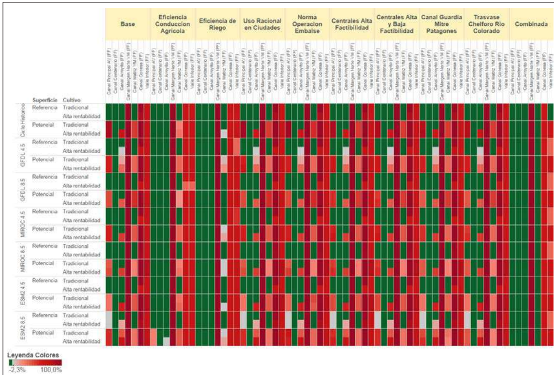
Figura 4. Frecuencia de falla de la capacidad de los canales de riego en la década 2041-2050, Diciembre-Febrero
