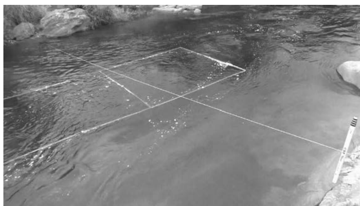
Figura 7. Marco de tamaño de 3m x 6m construido con tuberías de polipropileno bicapa de 0.0127m de diámetro, utilizado para la rectificación digital de imágenes registradas en la sección de medición emplazada en el Río San Antonio, en el ejido urbano de la ciudad de Villa Carlos Paz.
