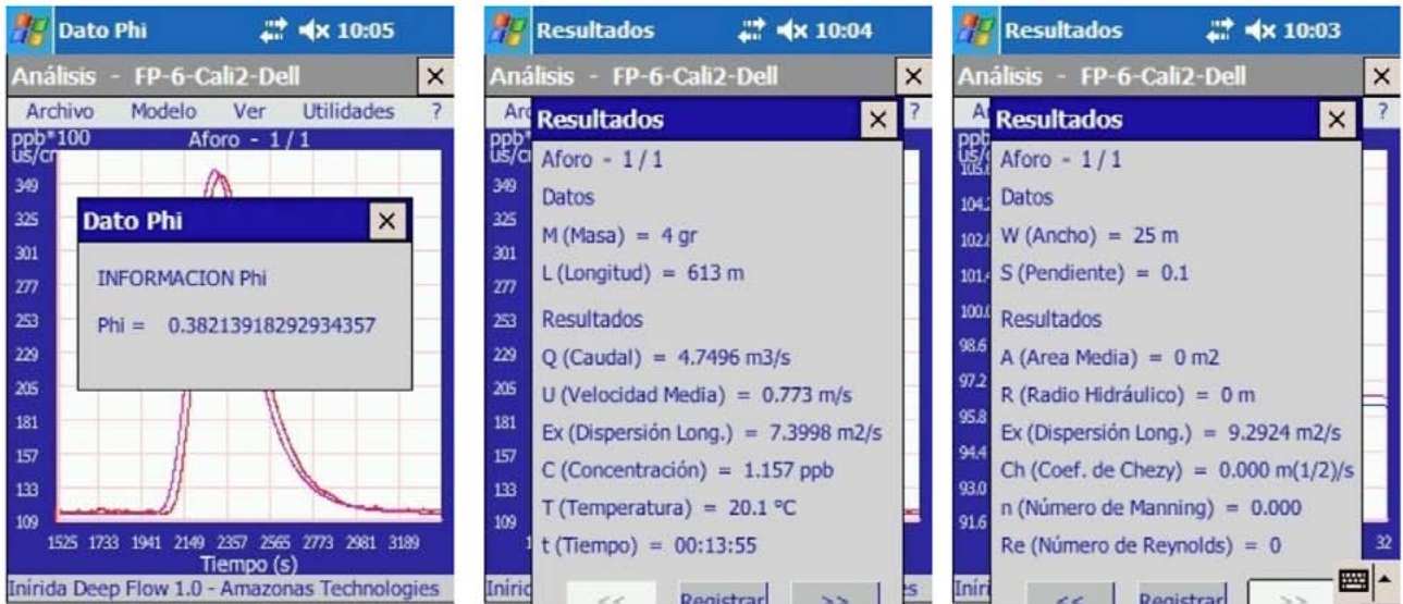
Figura 8. Pantallas con información grafica y numérica segundo vertimiento (parte B)
