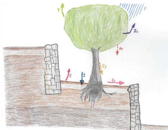
**Figura 1.** Balance hidrológico puntual en un bancal. P=Precipitación (mm); It=Intercepción (mm); T=Transpiración (mm); E=Evaporación (mm); Es=Escorrentía superficial (mm); I=Infiltración (mm); La escorrentía fustal (Ef) y el agua de trascolación (At) se evalúan dentro de la precipitación.
