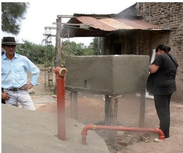
**Figura 12a.** Alternativa de bomba manual para aljibe construida con polipropileno. (Basán Nickisch y Sánchez, 2016)
